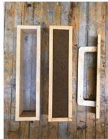
STEP I: POUR PULP INTO MOLD AND PRESS OUT WATER
